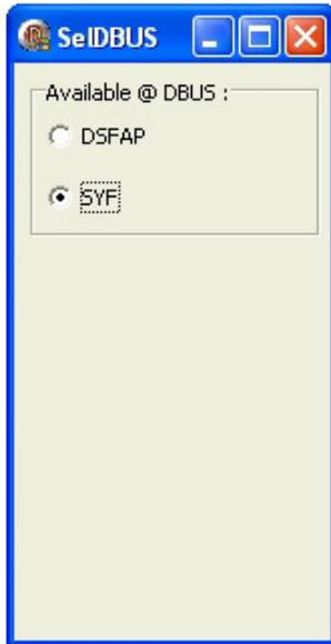
Wenn das Programmierkabel an der Anschlussbox (bzw. am Display bei der Version ohne AB) angesteckt ist, kann mit SelectDevice die Steuerung (zB. SYF) oder die Anschlussbox (zB. DSFAP) zur Programmierung ausgewählt werden.
